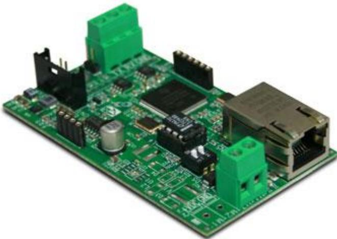
Verringerte Abmessungen, optimale Signalqualität sowie Unterstützung der häufigsten Netzwerk-Protokolle sind nur einige der Eigenschaften dieses Produkts, das eine Netzwerkverbindung mittels RJ45 an das Firmen-Computersystem erlaubt. Einfache Montage und Anschluss an den Wäge-Indikator über mitgeliefertes Kabel. Das Modul kann gemeinsam mit anderen DINI ARGEO-Produkten eingesetzt werden, wie z.B. mit Kontroll-Leuchte, Alibispeicher und Drucker (angeflanscht oder extern).
